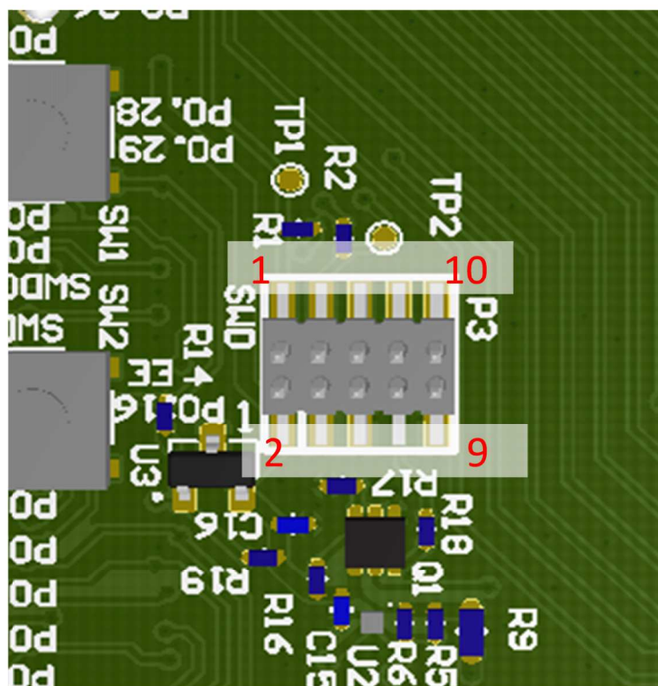
Figure 7: J-Link ピンヘッダ (P3) のピン No. 割り当て
