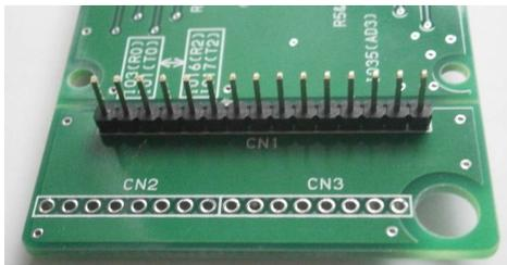
注意点1:基板の裏側から部品を実装して半田付けしてください。
